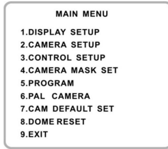
Рис. 11 Пример меню настройки PTZ-камеры.
