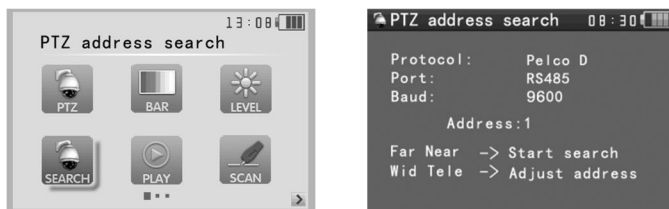
Рис.15 Подменю PTZ address search (PTZ-сканирование)
